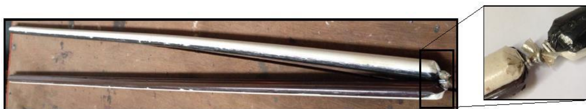
Figura 2 – Cartuchos de reação rápida e reação lenta, emendados por um grampo
