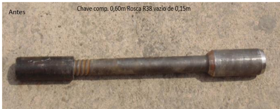
Figura 6 – Detalhe da chave inicial de testes
