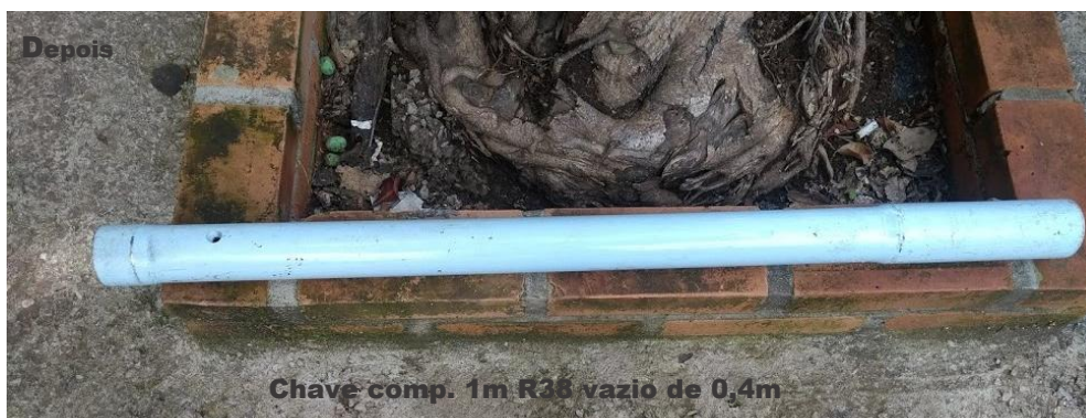
Figura 7 – Detalhe da chave com as melhorias implementadas
