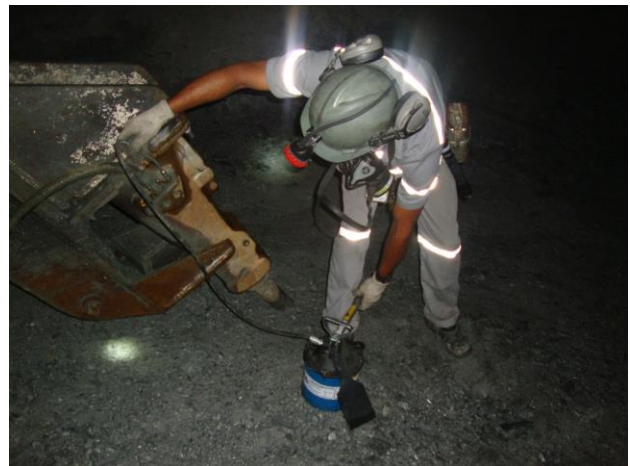
Figura 4. Processo de lubrificação manual do martelo do Scaler antes de iniciar a atividade.
