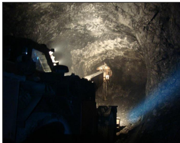
Figura 1. Imagem da operação de abatimento de choco mecanizado na unidade Morro Agudo da Votorantim Metais Zinco.
